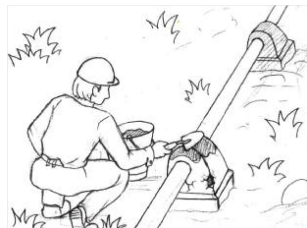
Hình 11: Trát vá bảo d-ỡng trụ đỡ đ-ờng ống.
